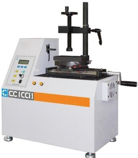
Bu cihaz, bir mamul ürünün dış tabanı ile üst malzemesi arasındaki soyulma direncinin belirlenmesinde kullanılmaktadır.
